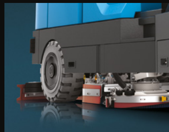
Roues super élastiques avant et arrière
